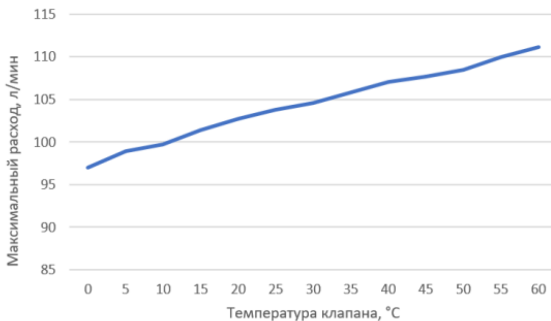
Рис. 4. Зависимость максимального потока от температуры для клапана Norgren IMI FAS
