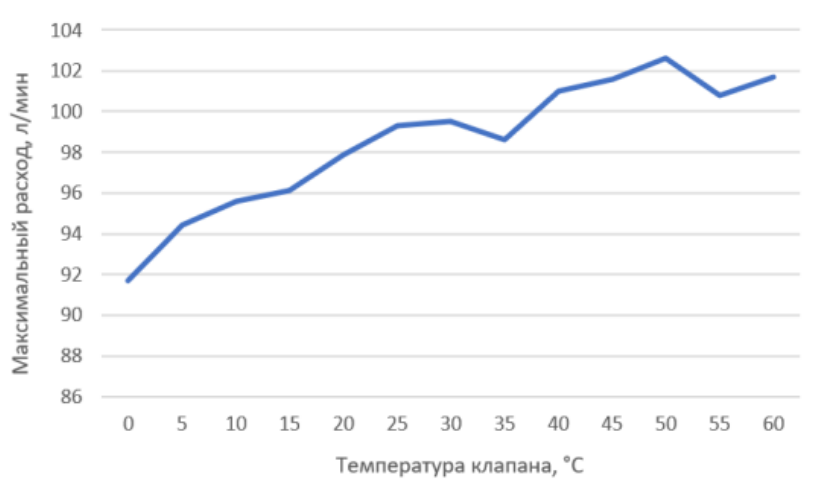
Рис. 5. Зависимость максимального потока от температуры для клапана ASCO 202
