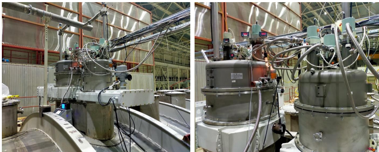
Рис. 7. Внешний вид насосов вакуумных криогенных НВК-900 и НВК-630 (производство АО «НТК Криогенная техника», г. Омск)
