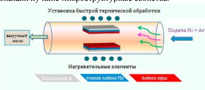
Рис. 10. Схема процесса изготовления тонких плёнок MoS_2 [14].
