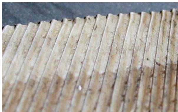
Рис. 4. Рельеф уплотняемой поверхности. Пластиковая поверхность с рельефом в 1мм.
