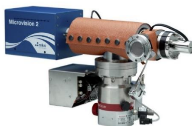
Рис. 3. Анализатор остаточных газов MKS Vision 2000-P.
