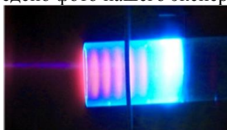
Рис.4. Периодические структуры, наблюдавшиеся в экспериментах (плазмообразующий газ воздух, P_m = 0,5-0,8 Торр).
