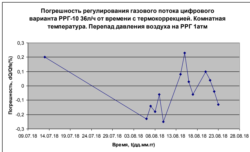
Рис.5. Основная приведенная погрешность РРГ-10 с цифровой платой внутри в различные дни измерений после двух часового прогрева при комнатной температуре с термокоррекцией.
