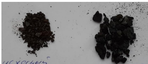
Рис. 4. Эффект воздействия ЭПП гелия на лигносульфонаты. Условия обработки: E_b = 27 кэВ, I_b = 2 мА, P_m = 5,0 Торр, длительность обработки \tau = 10 мин, характерная температура в объеме образца \approx 600-700 К.
