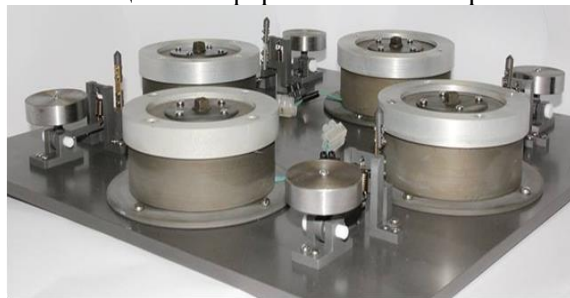
Рис. 1. Общий вид платформы на основе МР эластомера. (верхняя плита не показана)
