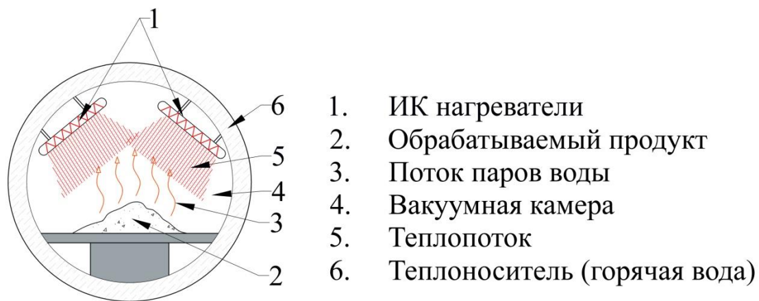
Рис. 5. Инфракрасные нагреватели в установке НОВ.
