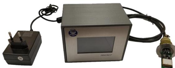
*Рис. 12. Вакуумметр резонансного типа.*
