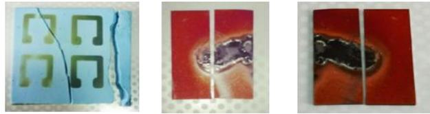
Рис. 2. Внешний вид образцов, подвергающихся перегреву и разрушенным в процессе нанесения покрытия.
