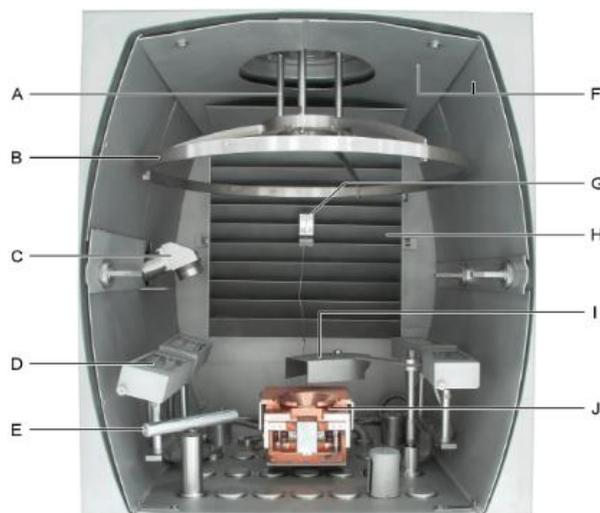
Рис. 1. Конфигурация вакуумной камеры установки:
