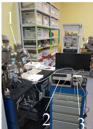
Рис. 1. Экспериментальный стенд контроля туннельного тока во время роста тонкой пленки.
