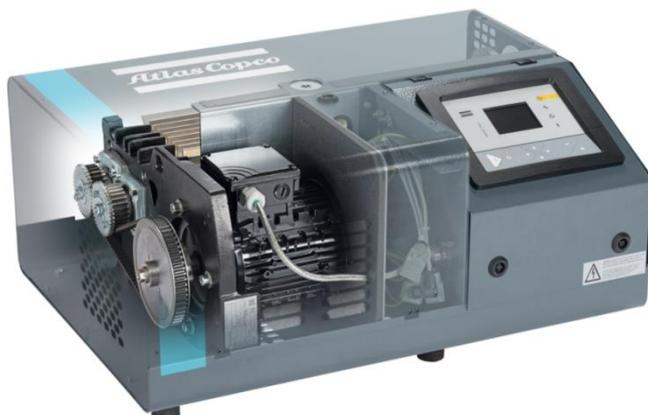
Работает насос очень тихо, уровень шума благодаря шумопоглощающему корпусу и системе привода с клиновым ремнем и VSD не более 70 дБ(А). Номинальная производительность насоса 65 и 100 м<sup>3</sup>/ч.
