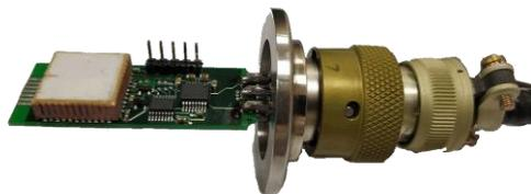
Рис. 7. Датчик давления по технологии МЭМС.
