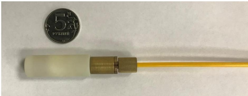
Рис. 4. Разрядник с узлом ввода оптического излучения.
