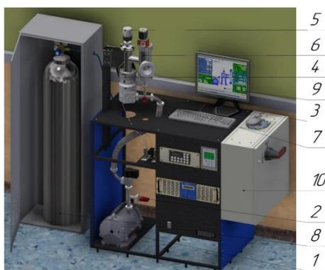
*Рис. 3. Вакуумная технологическая установка УВН-1М.*
