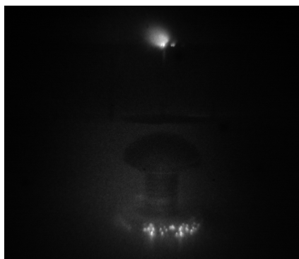
Рис.5. Фотография вакуумного разряда 2-го типа, начальная стадия.
