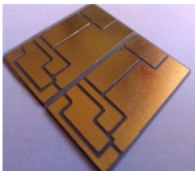
Рис. 2. Типовая коммутационная плата. Материал: керамика, размеры 48x60 мм, металлизация - медь.
