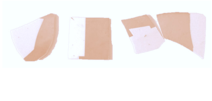
Рис. 6. Образцы ситалла с медным покрытием (от 1 до 4 слева-направо).
