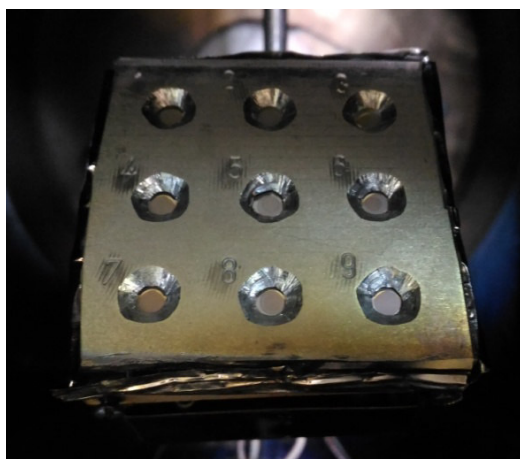
Рис. 1. Расположение резонаторов для измерения толщины и соотношения компонентов.
