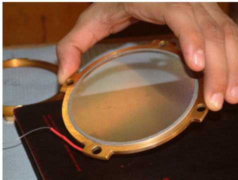
Рис. 1. Мембрана, использованная в резонансных экспериментах и временная зависимость амплитуды колебания при выключении накачки, T=44 мК, P=5 атм., особо чистый ^4\text{He} .
