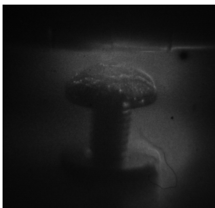
Рис.3. Фотография вакуумного разряда 1-го типа, начальная стадия.
