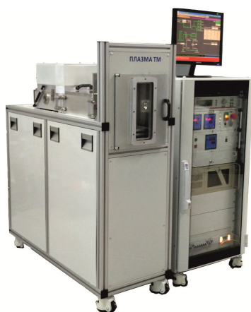
Рис. 14. Фото четырех видов установок с загрузкой пластин диаметром до 200 мм с помощью кассетного загрузчика.
