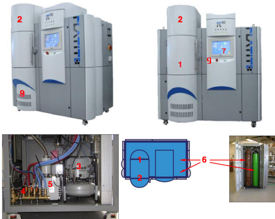
Рис. 1. Основные элементы: 1 – вакуумная камера, 2 – катод с крышкой, 3 – компрессор, 4 – подвод воды, 5 – форвакуумный пластинчато-роторный насос, 6 – баллоны с газом ( Ar , N_2 ), 7 – монитор, клавиатура оператора, 8 – вентилятор бокового канала, 9 – кнопка экстренного отключения.
