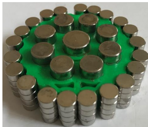
Рис. 4. Сепаратор магнитной системы с двумя областями плазмы: а) разрез 3D модели сепаратора по каналам для охлаждения; б) магнитная система в сборе.
