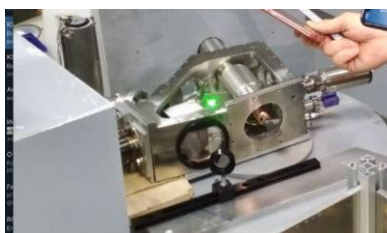
Рис 1. In-situ PLD установка на нейтронном рефлектometре MARIA @FRM-II
