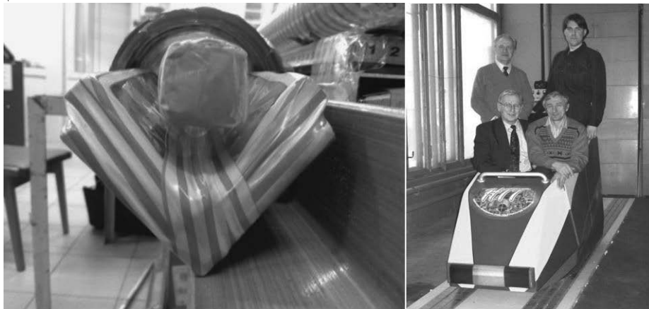
Рис. 1. Один из макетов ВЛКЛ на входе в вакуумную оболочку (слева) и магнитный ВТСП подвес грузоподъемностью 500 кг (справа) [3].
