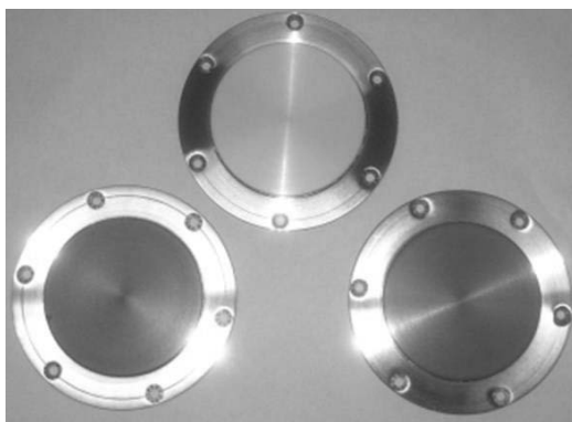
Рис.5. Мишени для магнетронного распыления, синтезированные методом SPS.
