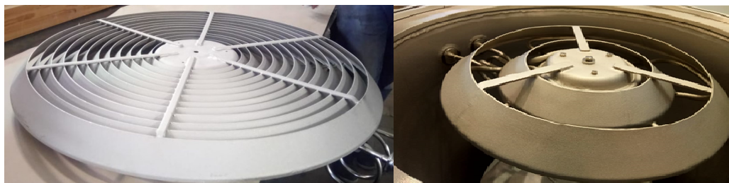
Рис.4. Новая интегрированная ловушка ЛИ и увеличенный маслоотражатель
