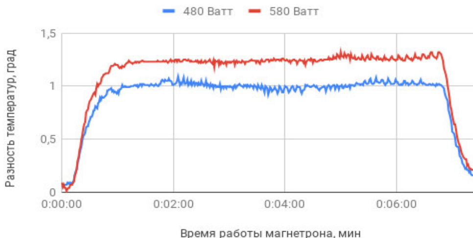
Рис. 2. Зависимость разности температур между патрубками от времени.
