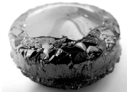
Рис.1. Разращенный монокристалл SiC.
