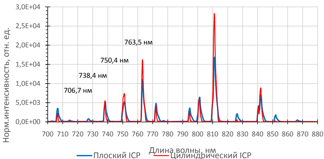
Рис.8. Нормированные оптические спектры излучения плоского и цилиндрического ИСР разряда Ar при давлении 10 Па, мощности ВЧ 100 Вт.
