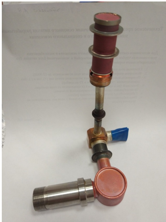
Рис.2. Вид рабочего прототипа рентгеновской трубки с автокатодом.
