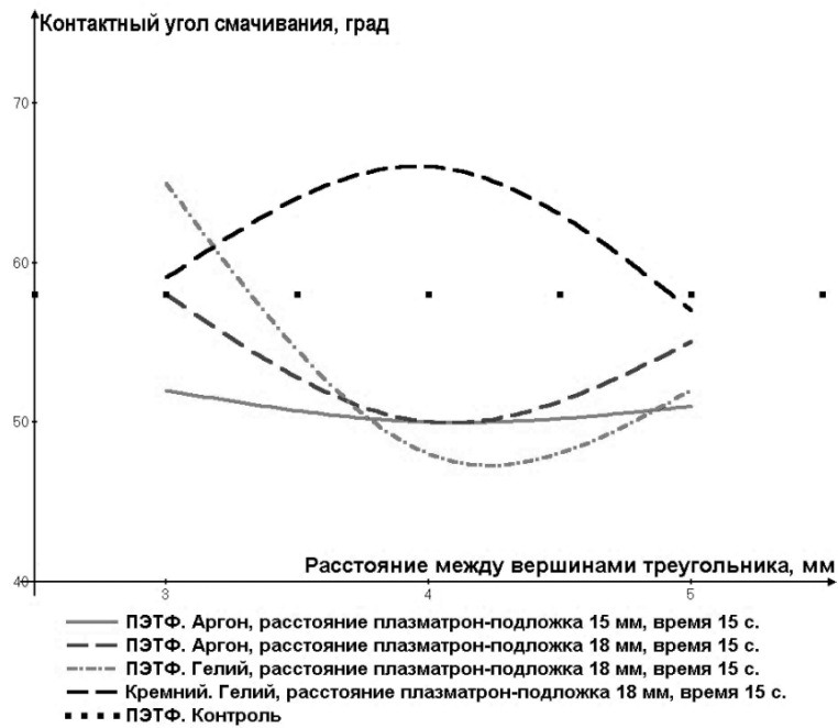
Рис. 5 Контактный угол смачивания полученных покрытий в зависимости от расстояния плазматрон-подложка, расстояния между точками треугольника и от используемого плазмообразующего газа.
