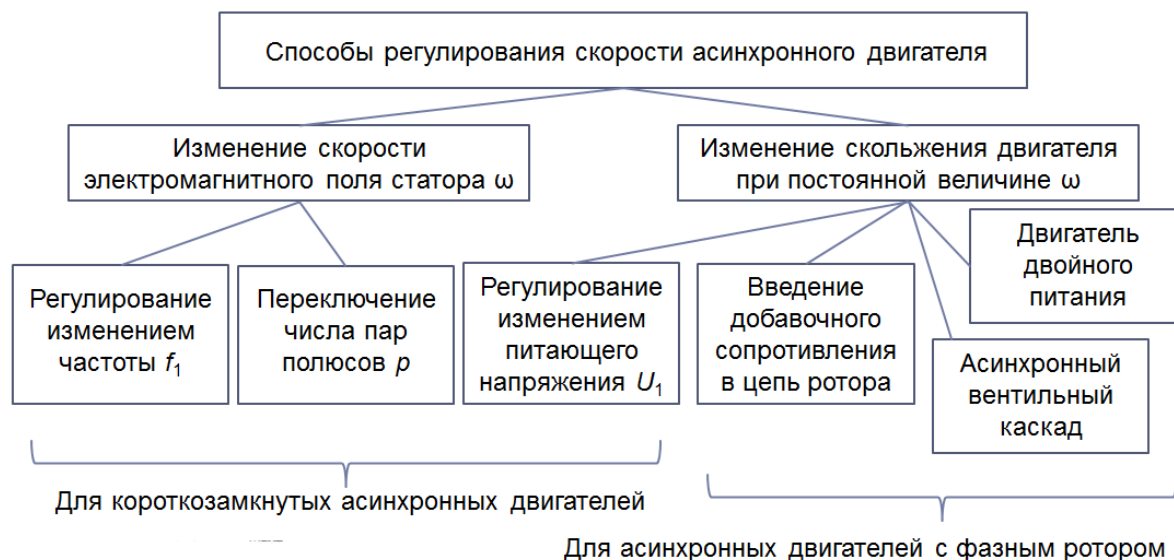
Рис. 5. Способы регулирования скорости асинхронного двигателя.
