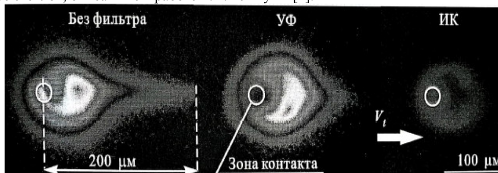
Рис. 1. Результаты изменения размера и яркости плазменного облака в процессе трения пары «алмаз-кварцевое стекло».
