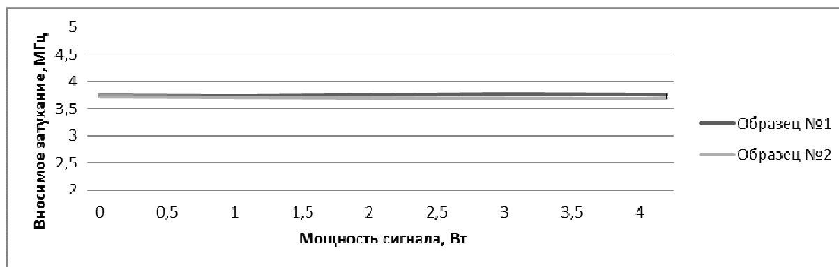
Рис.5 Результаты испытаний ПАВ-фильтра, реализованного на основе двухслойной структуры Ti-600Å/Al-2200Å.
