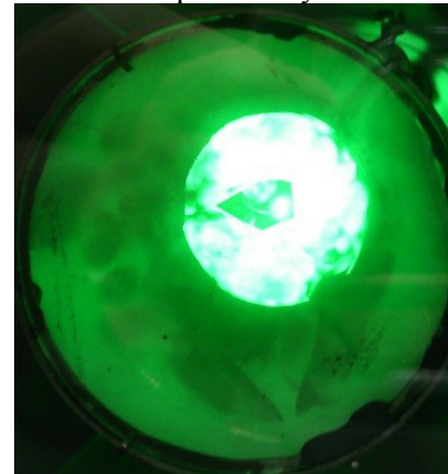
Рис. 2. Эмиссионные характеристики разработанной электронной пушки и автоэмиссионное изображение распределения потока электронов на аноде.
