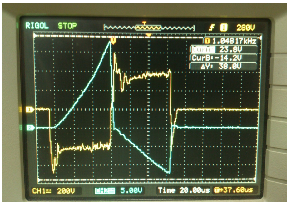
Рис.5. Осциллограмма тока и напряжения на дуальном магнетроне.
