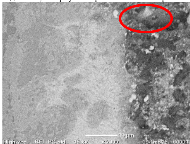
Рис. 3. Паяный шов ковар – ВК-94-1 с трещиной (обведена овалом) в верхней части по керамике (фото с электронного микроскопа JEOL 6000), увеличение 2000 x
