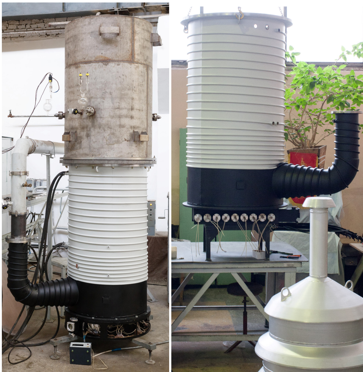
Рис. 10. Монтаж и испытания первого диффузионного вакуумного насоса DiJ 35.
