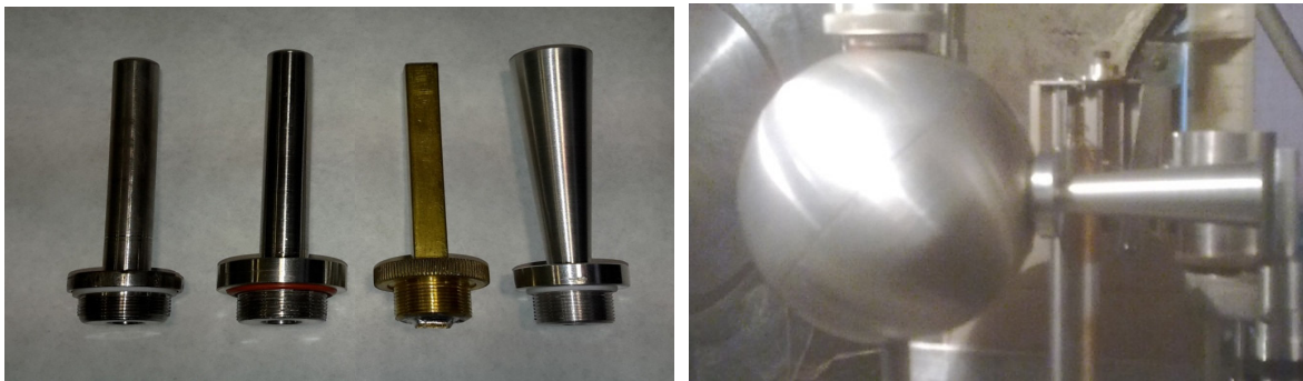
Рис. 3. Единичные заборники (а), заборник-конфузор с шаровым накопителем (б).
