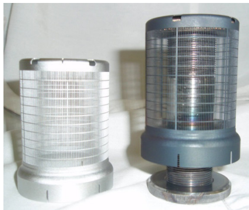
Рис. 3. Сеточный электрод перед обработкой (слева) и электрод на оправке после напыления покрытия на основе углерода (справа).
