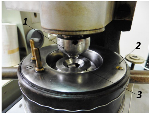
Рис. 2. Узел трения машины КТ-2[6]: 1 – шпиндель с установленным в нём шаром; 2 – масляная чаша; 3 – оправка с тремя роликами, установленными симметрично относительно оси шпинделя.
