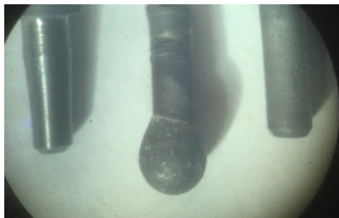
Рис.2. Фотография фильера: слева – до диспергирования, посредине – эта же фильера после диспергирования ErNi, справа – фильера с модифицированной поверхностью после диспергирования ErNi .
