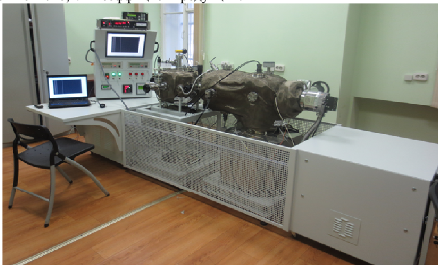
Рис. 2. Общий вид Вакуумметрической редукционной эталонной установки (ВРЭУ).
