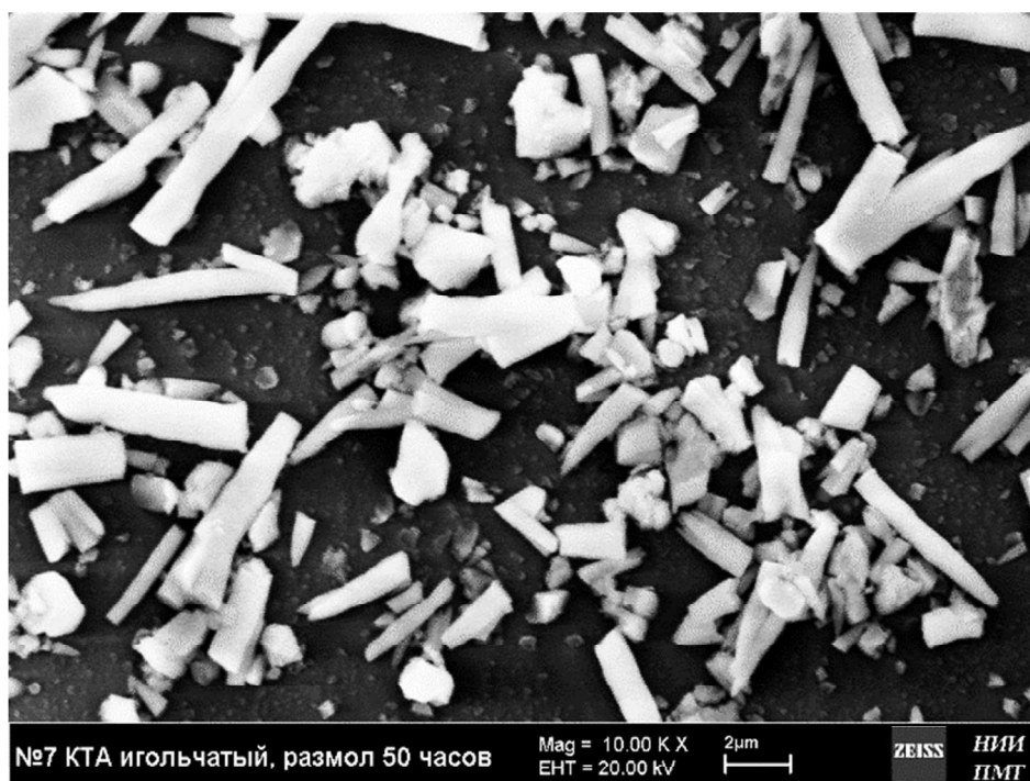
Рис.3. Результаты размола игольчатого тройного карбоната в течении 50 часов. (Увеличение в 10 000 раз)
