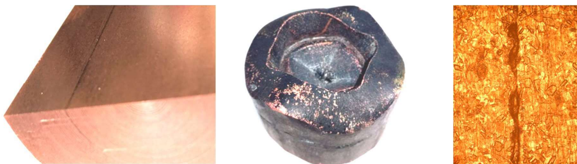
Рис. 1. КПО в прессованном прутке (слева, \times 2 ), разрушение поковки (в центре) и типичная макротрещина в зоне КПО (справа, \times 50 )
