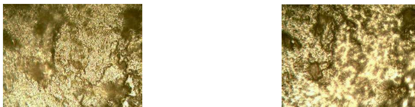
Рис. 5. Изображение одной и той же области эластомера с медным покрытием при разном фокусе на микроскопе МИИ-4М (увеличение \times 1000 )
