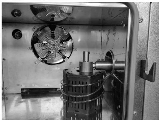
Рис. 3. Положение клапана в камере тепла и холода
