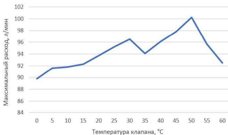
Рис. 6. Зависимость максимального потока от температуры для клапана АО «Плутон»
