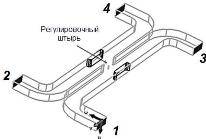
Рис. 2. Расчётная модель суммирующего устройства (суммирующее устройство).
