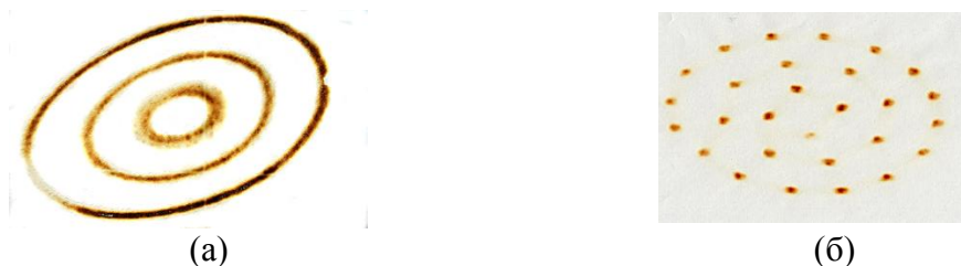
Рис. 2. Примеры паттернов сканирования ЭП в плоскости (x,y) при вращении оси его инъекции по концентрическим эллипсам: (а) – непрерывный ЭП, (б) - импульсно-периодический ЭП
