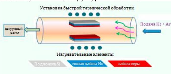
Рис. 10. Схема процесса изготовления тонких плёнок  $MoS_2$  [14].
