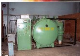
Серия установок ВАТТ 1600 («Казанская бочка»). **Самая популярная серия** установок первого поколения, более 35 единиц в различной комплектации: магнетронное, дуговое, термическое напыление, плазменная обработка, имитация космоса и др.
