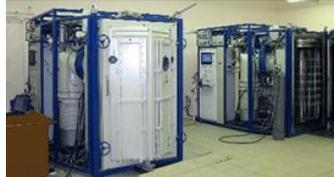
Серия напылительных установок ВАТТ 900 для различных задач нанесения декоративных и функциональных покрытий. В дальнейшем на ее базе создана серия установок ВАТТ 700.
