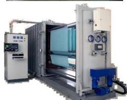
Серия вакуумных установок для **рулонных материалов** ВАТТ 4000 ПТ Плазма и ВАТТ 5000 Б Плазма.
