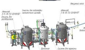
Автоматизированная вакуумная линия пропитки пористых сплавов ВАТТ-5-ВКП2,8. Открытие направления вакуумной **пропитки и формования** композитных материалов.
