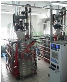
Серия установок зонной плавки **монокристаллов** тугоплавких металлов ВАТТ УЗП-800.
