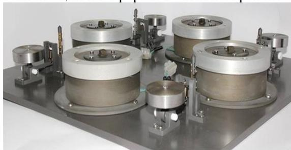
Рис. 1. Общий вид платформы на основе МР эластомера.
