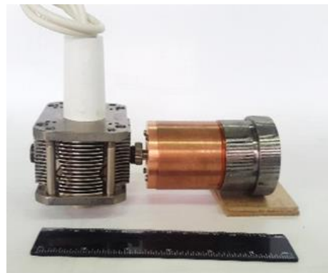
Рис. 5. а) Магнетрон с «быстрой» электронной перестройкой частоты; б) Магнетрон со стабилизацией частоты
