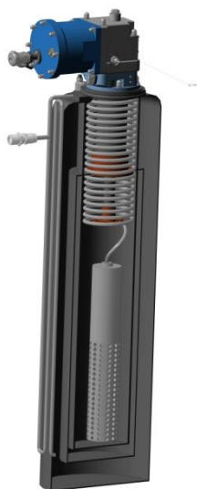
Рис. 3. Блок криогенной очистки гелия.
