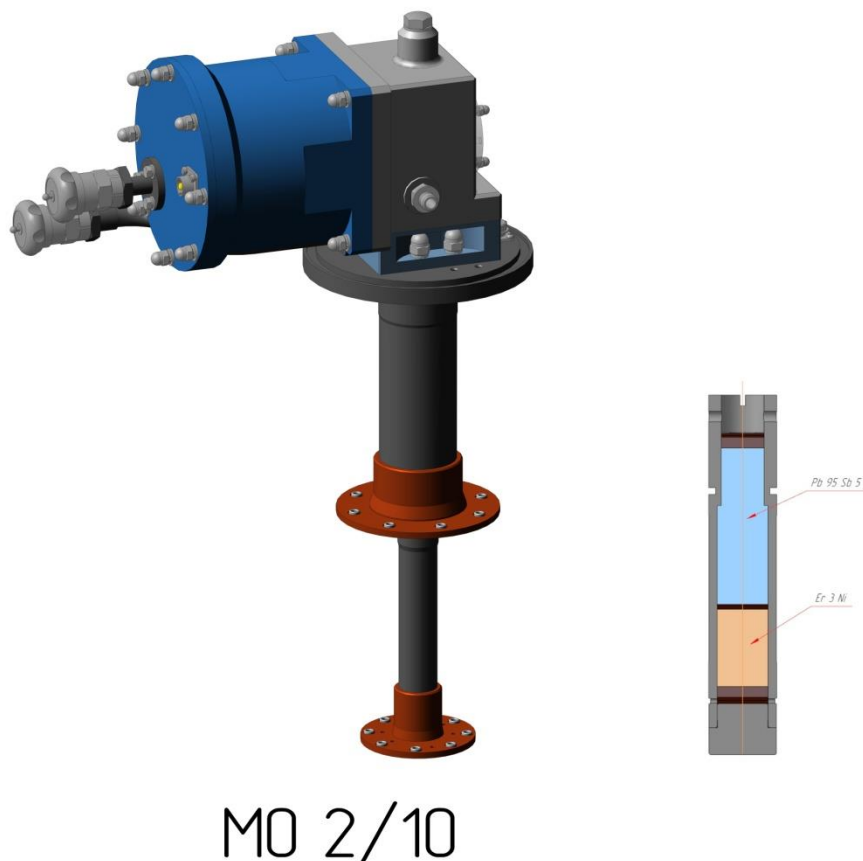
Рис.4. Внешний вид и разрез вытеснителя второй ступени МО 2/10.
