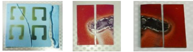
Рис. 2. Внешний вид образцов, подвергающихся перегреву и разрушенным в процессе нанесения покрытия.
