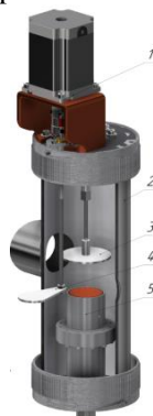
Рис. 5. Оснастка установка УВН-1М. 1 – система ввода вращения заслонки; 2 – камера вакуумная; 3 – подложкодержатель; 4 – заслонка; 5 – модуль магнетрона.
