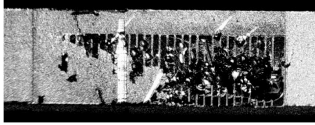
Рис. 5. Внешний вид паянного шва с удаленной ЛЛД. Область слева – отсутствие смачивания металлизации ЛЛД припоем золото-олово, полосы – следы контакта эмиттеров ЛЛД, темные и светлые участки произвольной формы – осколки ЛЛД, оставшиеся после демонтажа.
