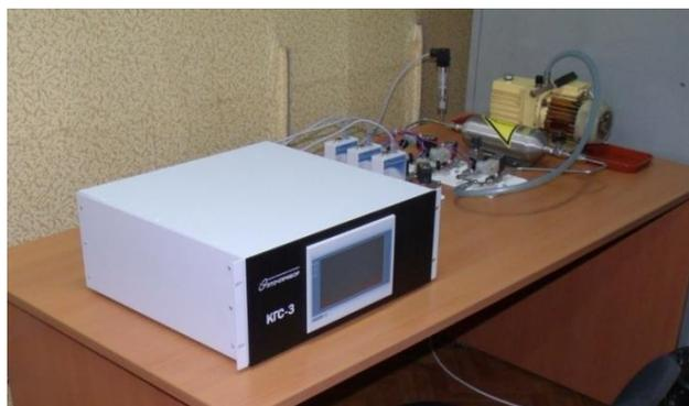
Рис. 1. Контроллер газовой системы КГС-3 и газовая система.
