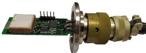
Рис. 7. Датчик давления по технологии МЭМС.
