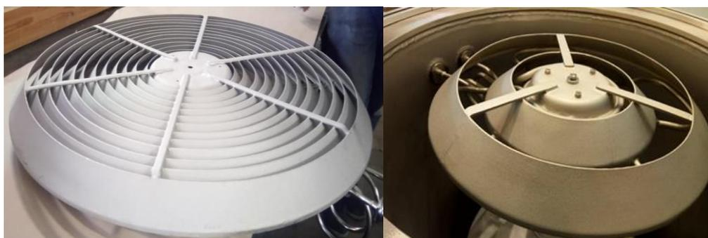
*Рис.4. Новая интегрированная ловушка ЛИ и увеличенный маслоотражатель.*
