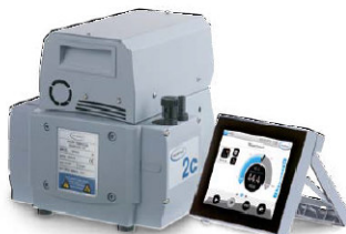
Рис. 3. Мембранный насос MV 2 NT VARIO; 0,3 мбар 3,3 м 3 /ч.
