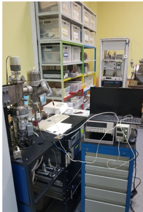
Рис. 2. Стенд контроля начальных стадий роста ОТП.
