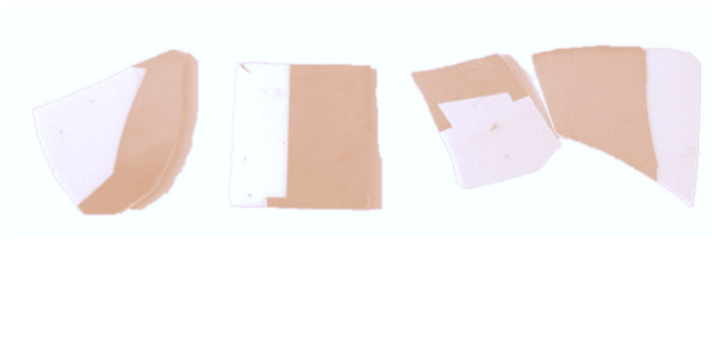
Рис. 6. Образцы ситалла с медным покрытием (от 1 до 4 слева-направо).
