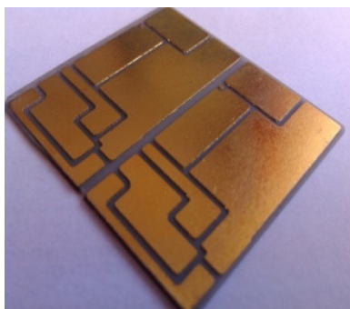
Рис. 2. Типовая коммутационная плата. Материал: керамика, размеры 48x60 мм, металлизация - медь.
