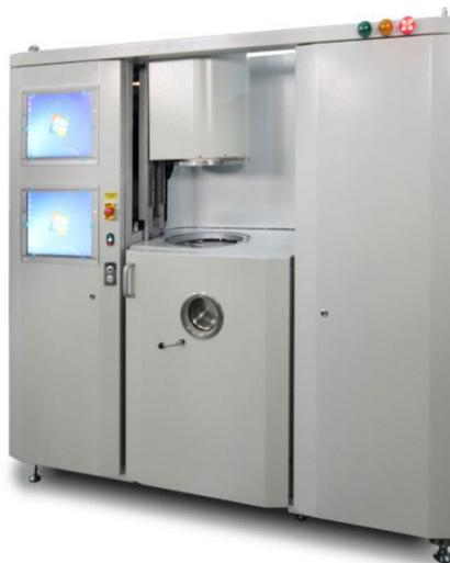
Интеграция с напылительными контроллерами вакуумной установки позволяет реализовать процесс напыления покрытия от начала и до конца полностью автоматически. Важно отметить что, при необходимости, программа может проводить оптимизацию расчета последующих слоев и изменять рецепт в режиме «онлайн» для получения наилучшего совпадения финального покрытия с расчётным.
