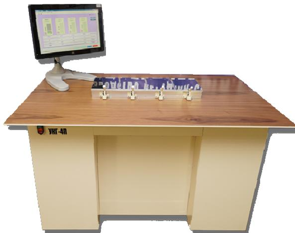
Оператором программно может быть задействовано в работе нужное количество пеналов. Минимальное время подготовки задается также программно. Информация о работе установки и результат контроля каждого пенала выводится на встроенный компьютер и отображается на мониторе. Стартом продолжения контроля последующего пенала является закрытие крышки загружаемого пенала.
