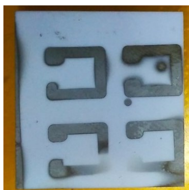
Рис. 5. Внешний вид тестовых проводящих дорожек, полученных на алюмооксидной керамике.
