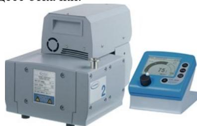
Рис. 3. Мембранный насос MV 2 NT VARIO; 0,3 мбар 3,3 м<sup>3</sup>/ч.
