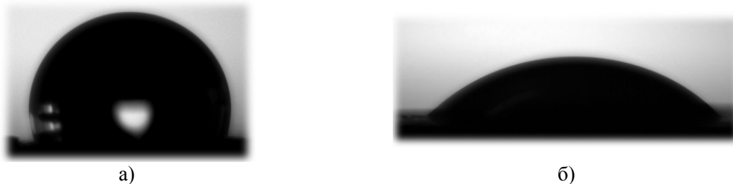
Рис. 2. Изменение гидрофильности поверхности образца ММА при его модификации в плазме ВЧ-разряда
