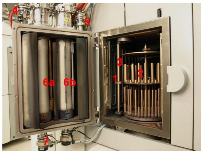
Рис. 2. Внутренние элементы камеры: 1 – нагреватель, 2 – карусель, 3 – держатель храповиков, 4 – система охлаждения катода, 5 – ударник, 6а – катод 1, 6б – катод 2, 7 – приводы заслонки.
