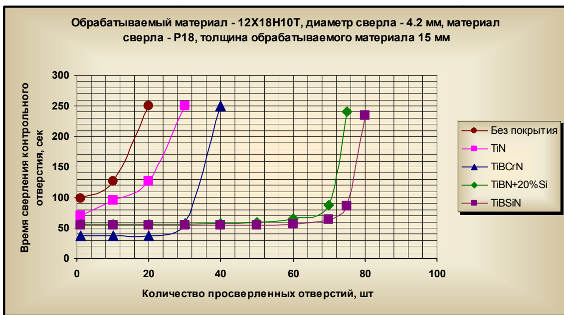
Рис. 1 Экспериментальная зависимость времени сверления от количества просверленных отверстий и материала покрытия при одинаковой нагрузке на сверло.
