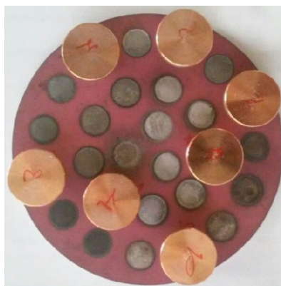
Рис. 3. Диск с припаянными образцами.
