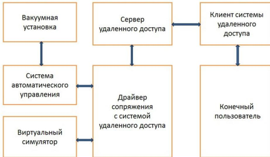
Рис. 3. Общая схема организации удаленного доступа к оборудованию.
