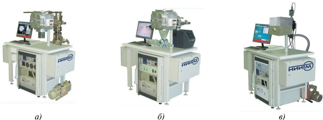
Рис. 4. Малогабаритные вакуумные установки ОАО НИИТМ:
