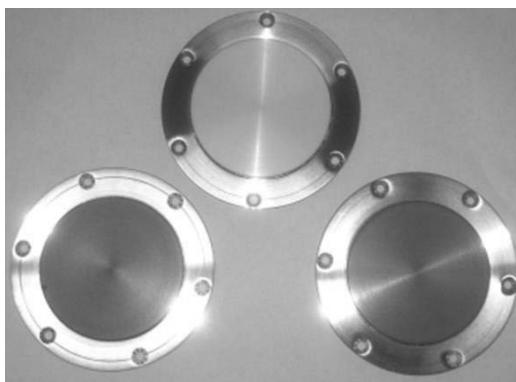
Рис.5. Мишени для магнетронного распыления, синтезированные методом SPS.
