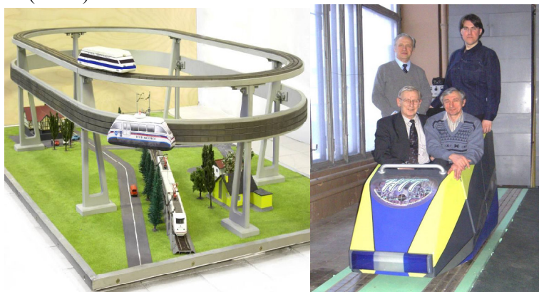
Рис 2. Действующая модель МАИ "атмосферного" МЛТ (слева) и магнитный ВТСП подвес грузоподъемностью 500 кг (справа)[27]
