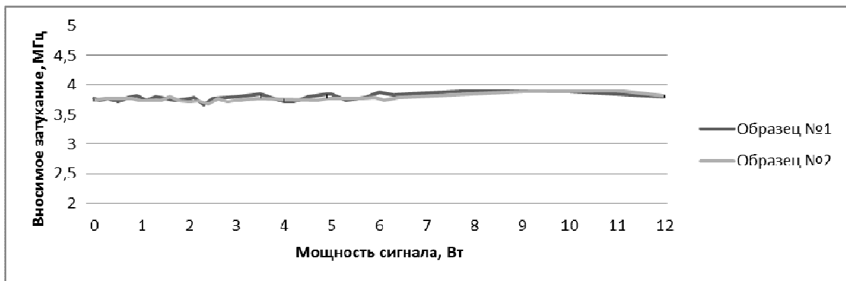
Рис.3. Результаты испытаний ПАВ-фильтра, реализованного на основе двухслойной структуры Ti-300Å/Al-2700Å.
