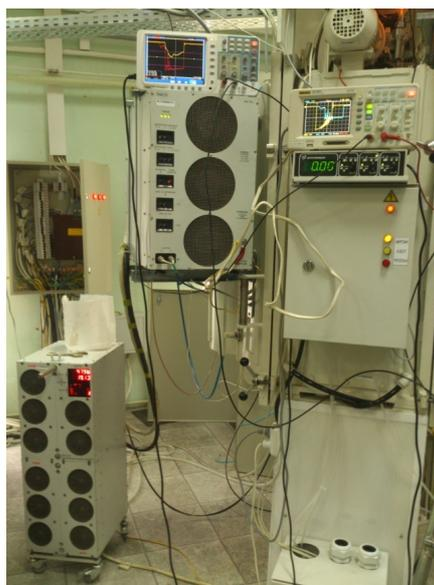
*Рис.4. Система питания одиночного магнетрона.*
