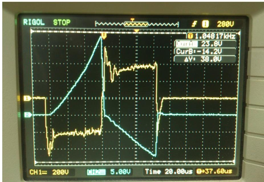
Рис.5. Осциллограмма тока и напряжения на дуальном магнетроне.
