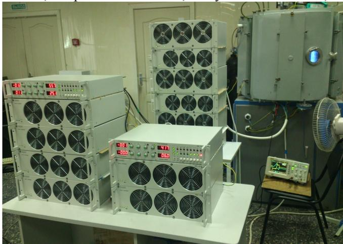
*Рис.3. Система питания дуальных магнетронов.*
