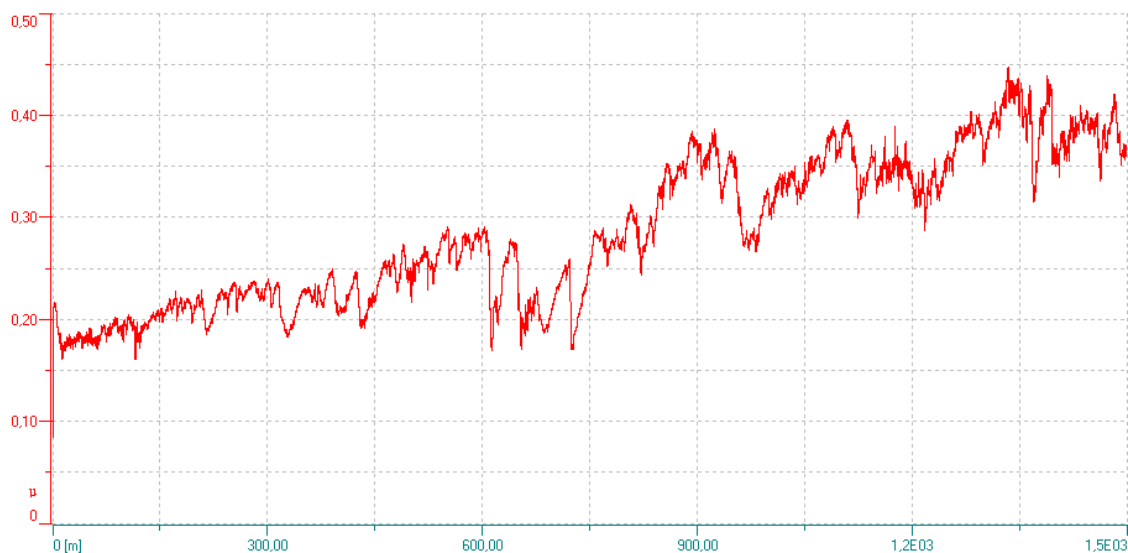
Рис. 1. Зависимость коэффициента трения от пути для образца с покрытием TiC-MoS 2 ( h_{TiC}=2,2 мкм; h_{MoS_2}=2,1 мкм) в паре с контртелом - шаром из WC.
