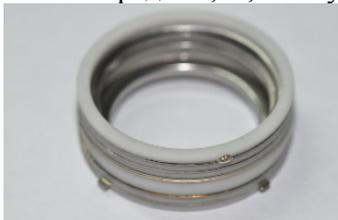
Рис. 4. Внешний вид нового промышленного прототипа МКК, спаянного активной пайкой в вакууме.
