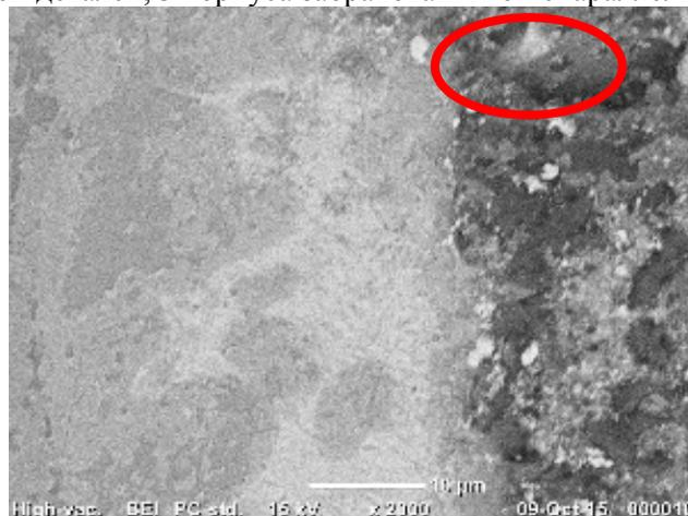
Рис. 3. Паяный шов ковар – ВК-94-1 с трещиной (обведена овалом) в верхней части по керамике (фото с электронного микроскопа JEOL 6000), увеличение 2000<sup>x</sup>
