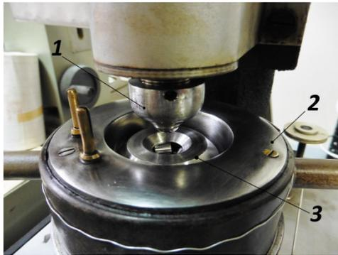
Рис. 2. Узел трения машины КТ-2[6]:
