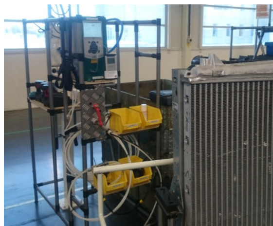
Рис. 4. Установка контроля герметичности радиаторов на автомобильном производстве.
