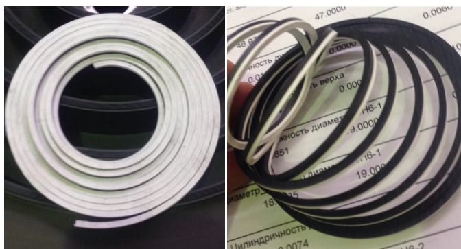
Рис. 4. Двухслойный торцевой уплотнитель отечественного производства.
