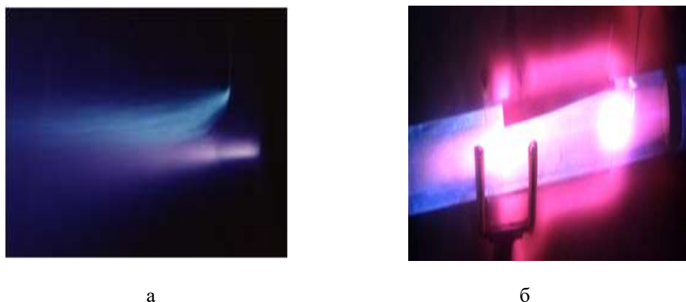
Рис. 4. Плазменный поток жидкого аэрозоля: а – керосин, распыленный в свободном потоке ЭПП воздуха; б – метиловый спирт, распыленный в ГП метана внутри цилиндрического канала.
