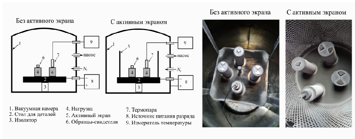
Рис. 1. Схема и внешний вид экспериментальной установки с активным экраном и без активного экрана.
